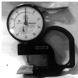
Figura 1. A - Micrômetro de alta precisão usado na aferição dos cones de guta-percha. B - Aferição do D_{16} .
