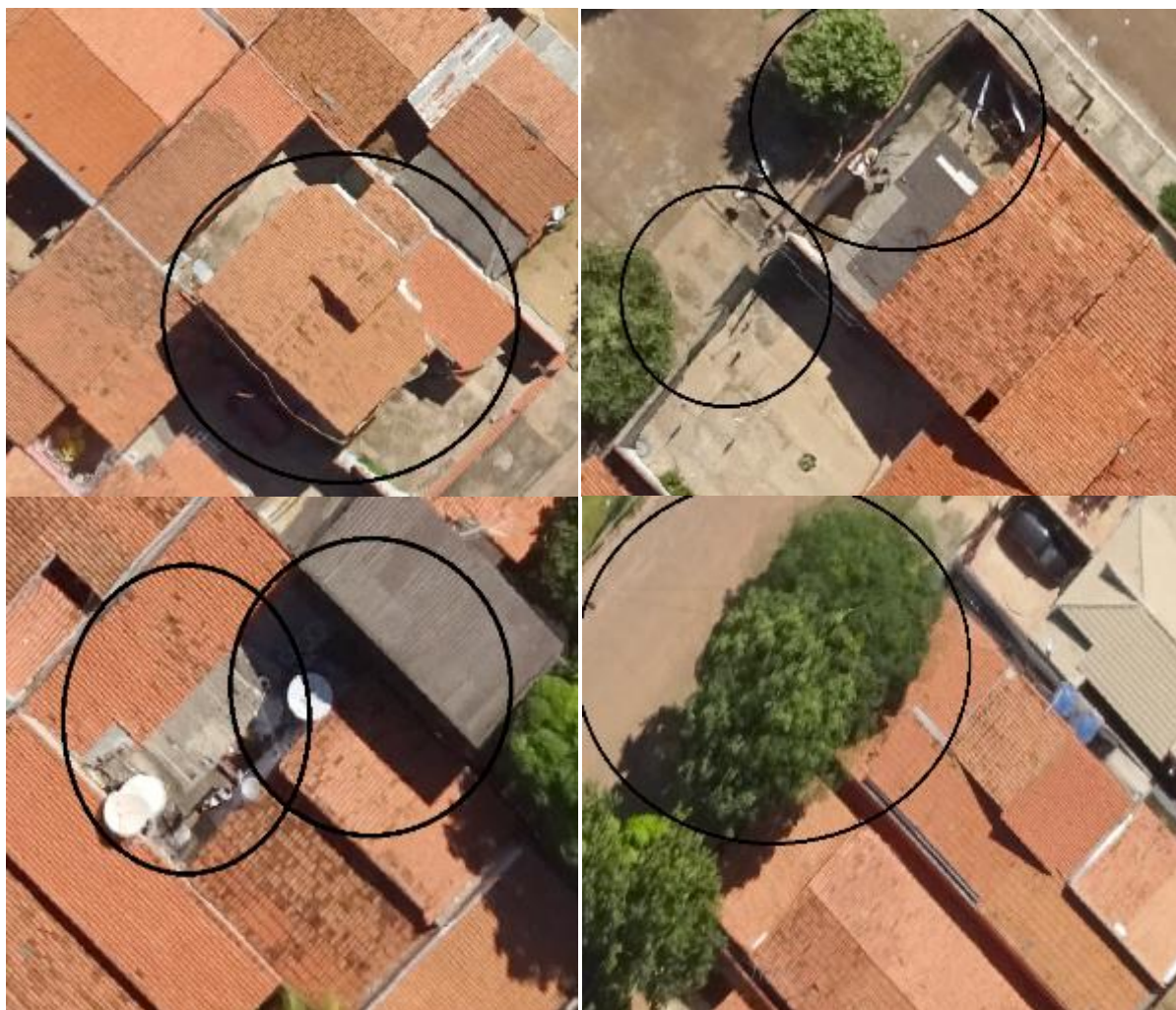
Figura 10. Distorções em vértices e arestas das edificações, sombreamento por diferença de altura e copa de árvore e construção anexa. Fonte: AUTOR, (2018).
