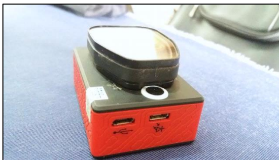
Figura 3. Conexões da câmera Sequoia. Fonte: Autores, 2019.
