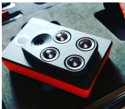
Figura 2. Câmera Multiespectral Parrot Sequoia. Fonte: Autores, 2019.
