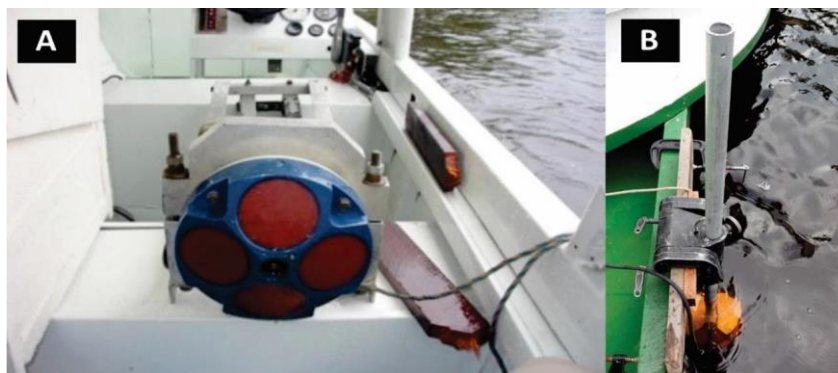
Figura 3. A) ADCP utilizado na pesquisa, B) em operação na embarcação, mergulhado na lateral da embarcação a 50 cm da linha d'água. Fonte: André Z. Nascimento.
