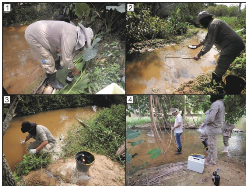
Figura 4 – Amostragem da alíquota para análises de DBO e DQO no ponto IM-03 (1). Medição de parâmetros físico-químicos no ponto IM-05 (2). Amostragem no ponto IM-04 (3). Amostragem no igarapé Acará (IA-01), logo à jusante do seu encontro com as águas contaminadas do Matrxixã (4).
