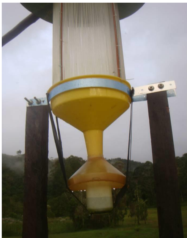
Figura 3. Água de chuva coletada pelo coletor cilíndrico protegido por cobertura cônica de folha de zinco. (Foto: Francisco Carlos Soriano Arcova, 20/01/2011)
