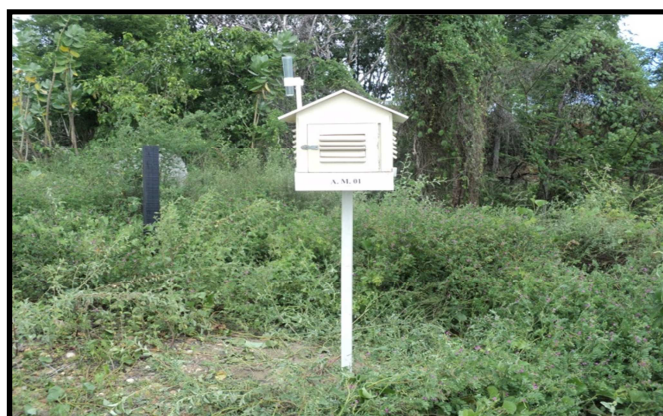
Figura 01 : Abrigo meteorológico instalado na margem do açude no município de Alto Santo. Fonte: Trabalho de campo, 2011.
