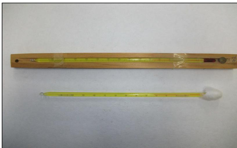
**Figura 04** - Termômetros de bulbo úmido e bulbo seco utilizados em trabalho de campo.
