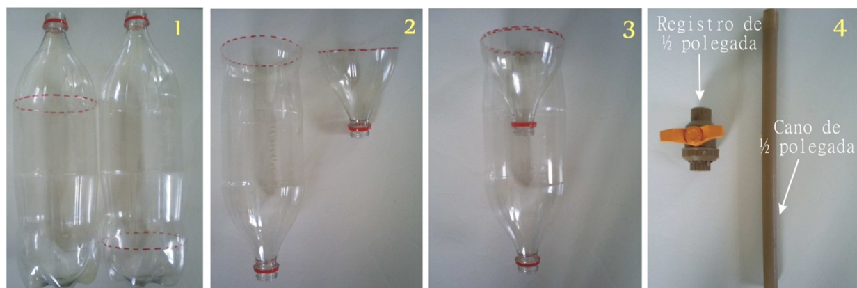
Figura 5- Materiais utilizados na montagem de um pluviômetro (1 e 4). Etapas para a confecção do reservatório. Elaboração: BRITTO, M.C.
