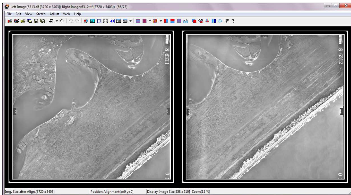
Figura 1: Par estereoscópico de fotografias aéreas abertas simultaneamente na janela principal do aplicativo StereoPhoto Maker .
