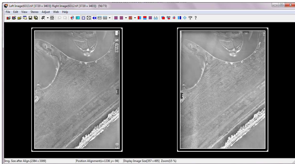
Figura 3: Janela principal do StereoPhoto Maker mostra as imagens direita e esquerda somente com as áreas em comum do par estereoscópico.
