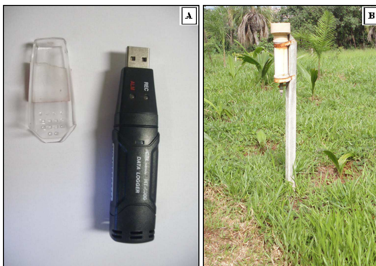
Figura 2 – A) Termohigrômetro, B) HT4000 e pluviômetro Foto: José Ricardo Rodrigues Rocha, (2011)
