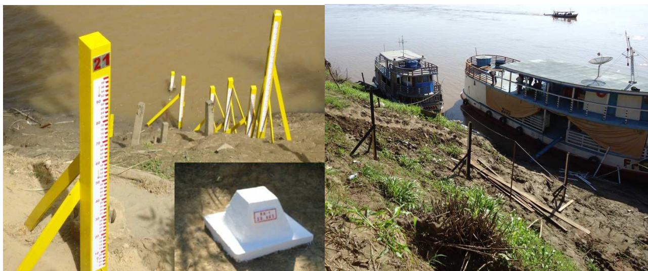
Figura 02: Régua linimétrica e RN fixado a poucos metros da ultima régua da estação fluviométrica de Abuña(RO) e ao lado direito a estação de Humaitá(AM) onde os barcos encostam em cima das régua submersas (Muniz, 2011).
