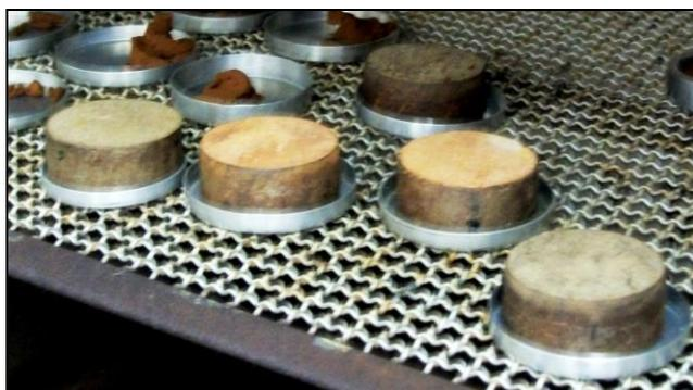
Figura 4: Amostras do material coletado em campo, onde foram conservadas suas características estruturais (amostras não deformadas), necessárias para os ensaios de condutividade hidráulica e de porosidade total.
