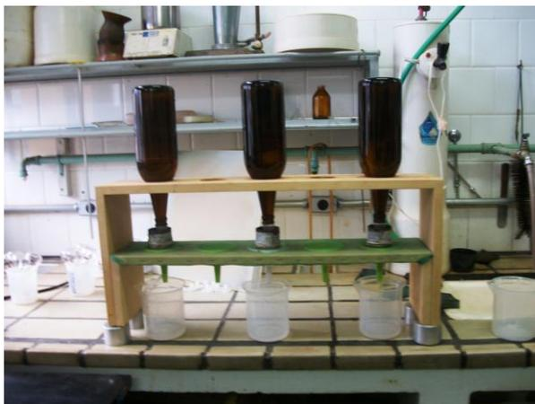
Figura 5: Imagem do permeâmetro adaptado, com estruturas de madeira e garrafas de vidro como reservatórios de água, notar a presença das amostras indeformadas e de béquer como recipiente coletor da água percolada.
