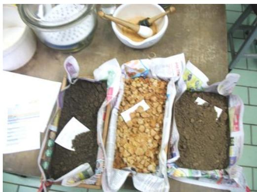
Figura 3: Ilustra as três amostras deformadas coletadas nas áreas de estudo e ao fundo o recipiente para destorroamento do material (solo e/ou rocha) com dois destorroadores e o dessecador.
