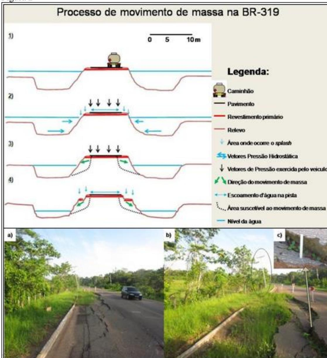
Esquema representativo do processo de movimento de massa demonstrando o nível da água no terreno; A) Movimento de massa; b) indícios de rastejo; c) recalque de 30 centímetros. Coordenadas: s 03°13'43.0" w 059°51'56,6" (org) Thiago Oliveira Neto.
