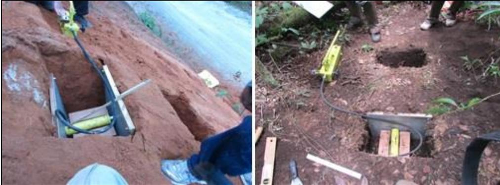
A esquerda teste de cisalhamento em bloco de solo em área não vegetada. A direita teste de cisalhamento em bloco de solo em área florestal.
