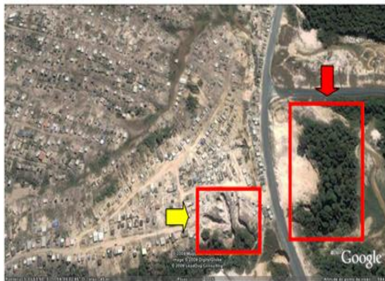
Figura 12: Voçoroca do tipo conectada com vegetação rarefeita (seta amarela) e concentração de vegetação do outro lado da avenida (seta vermelha) próximo a feição erosiva no bairro Distrito 2/Manaus.
