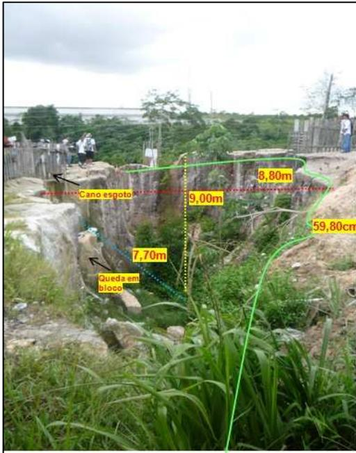
**Figura 05:** Foto voçoroca 1, tipo retangular de 59,80 m de comprimento.
