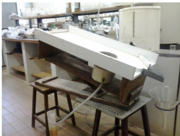
Figura 3. Rampa para o ensaio de Inderbitzen(Foto: Silva, 2014)
