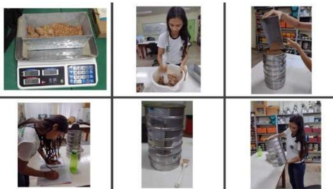
**Figura 7:** Procedimentos adotados para análise granulométrica por peneiramento ABNT-NBR 7181, 2016. **Fonte:** Autoria própria, 2023.
