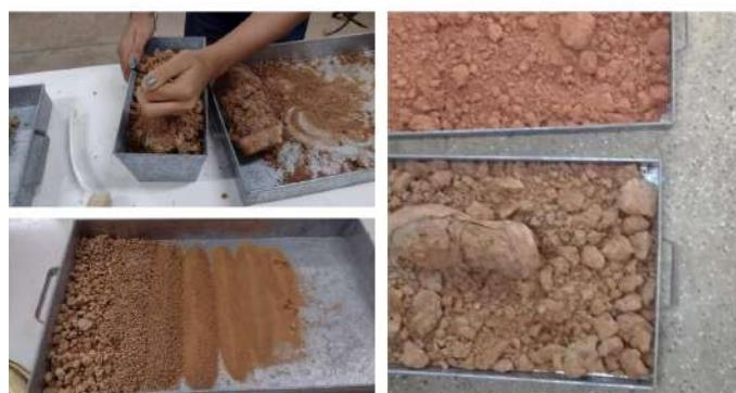
**Figura 8:** Procedimentos adotados para análise granulométrica por peneiramento ABNT-NBR 7181, 2016. **Fonte:** Autoria própria, 2023.
