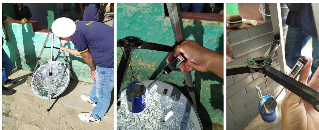
Figura 1 - Forno Parabólico. Visualização do aquecimento da água com um termômetro.
