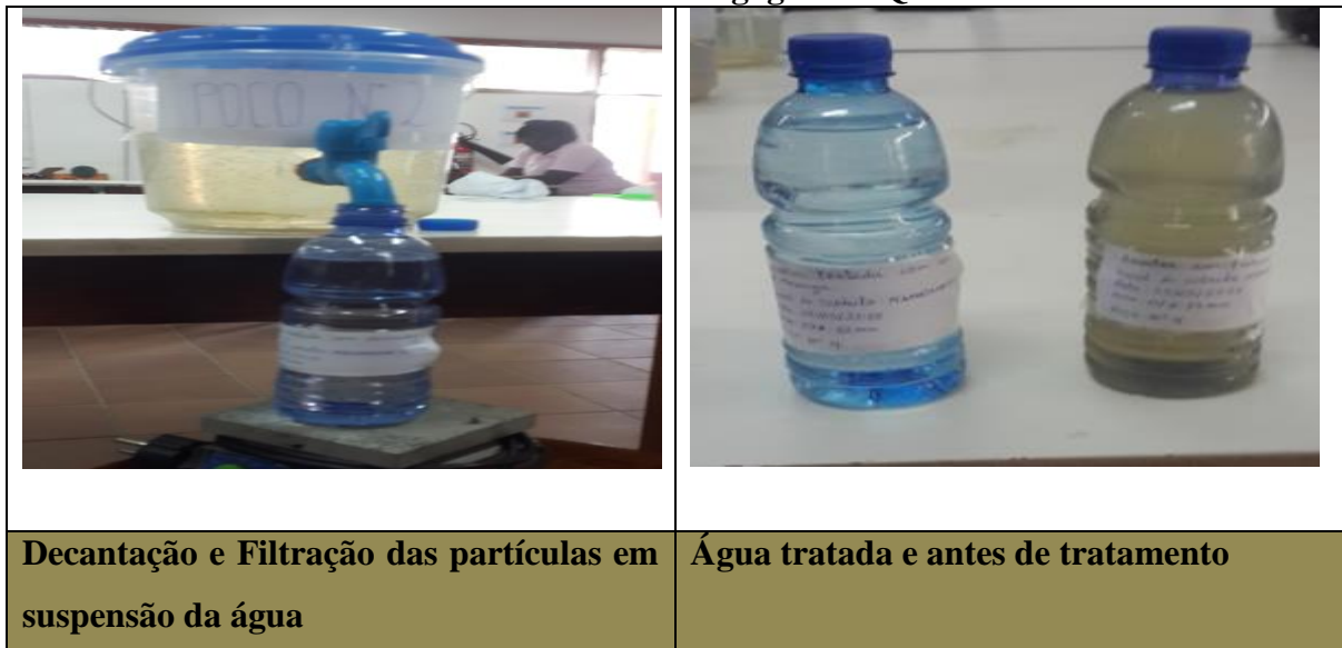
Figura 2: Tratamento de água a partir do pó de semente de Moringa oleifera , realizada no laboratório da Universidade Pedagógica de Quelimane
