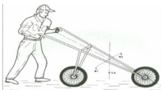
Fig.3: Equipamento manual montado sobre duas rodas uma atrás da outra, mostrando a distribuição de pesos W/2 e a localização do centro de gravidade (CG).
