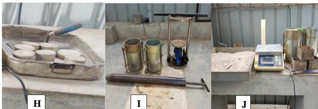
**Figura 5:** Materiais usados na determinação de ensaio de compactação de Proctor e CBR (Autores, 2019).
