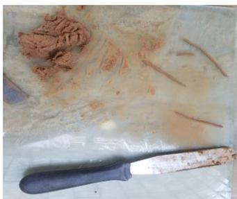
**Figura 4:** Ensaio do limite de liquidez. (Autores, 2019)
