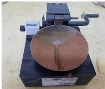
**Figura 3:** Ensaio de limite de liquidez. (Autores, 2019)
