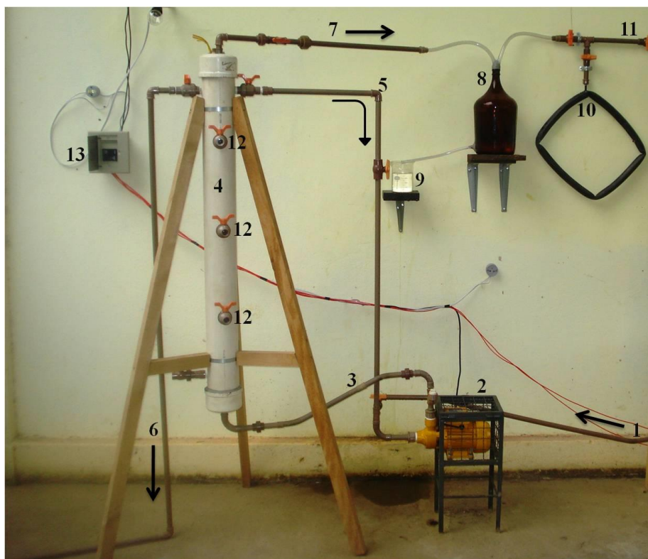
Figura 1 - Reator anaeróbico de fluxo ascendente e leito fixo.
