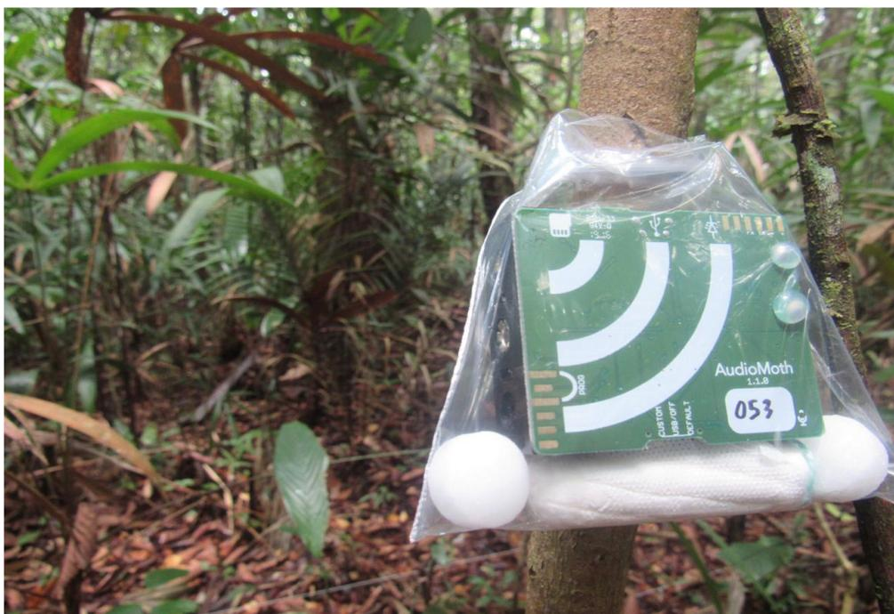
Figura 1. Fotografia demonstrando um gravador autônomo instalado no segmento 120-130 m de uma parcela RAPELD. Em primeiro plano um gravador com um material absorvente para evitar umidade, bem como naftalinas para afugentar insetos. Ao fundo é possível ver as linhas de demarcação do corredor central da parcela.
