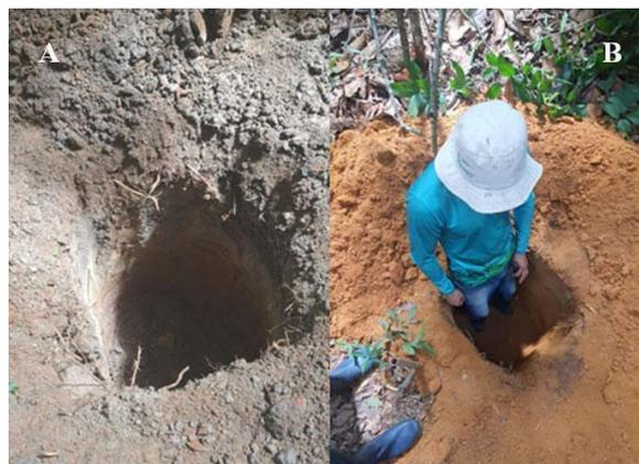
Figura 4 -Abertura (A) e limpeza (B) da trincheira de 1m<sup>2</sup> para análise de densidade do solo.
