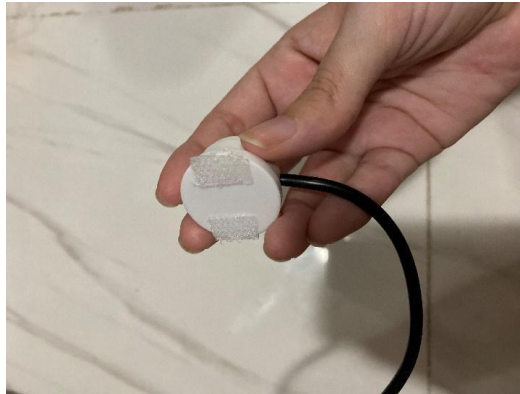
Figura 10- Velcro colado no sensor
