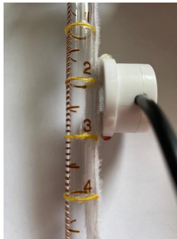
Figura 11 - Marcação tátil no sensor
