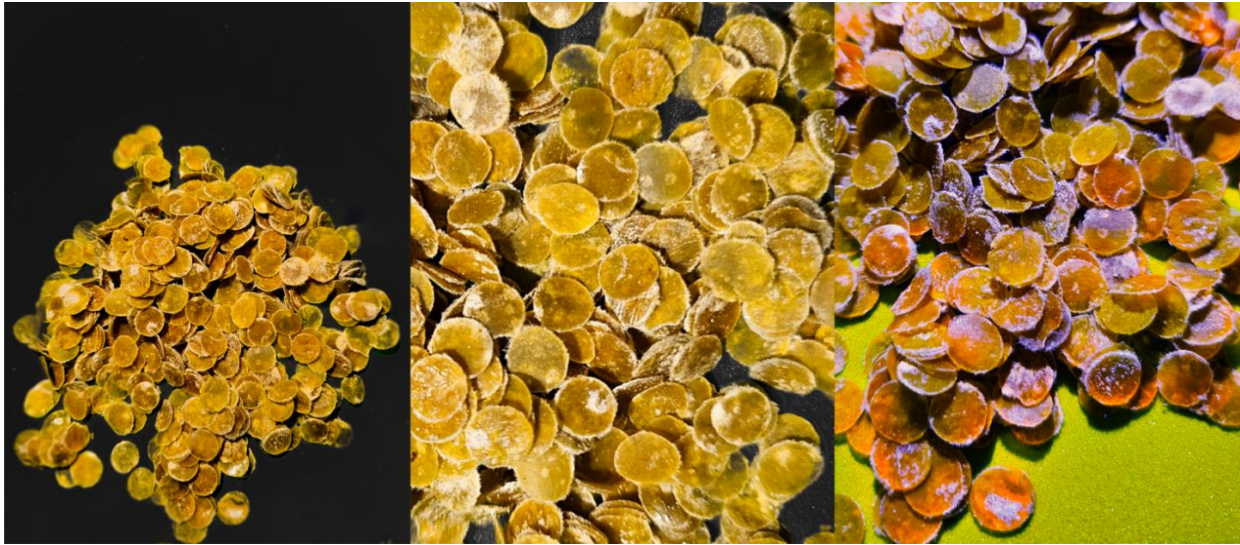
Figura 05 – Amostras do material fabricado com presença de fungo
