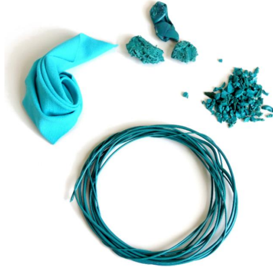
Figura 1 – Etapas de transformação do resíduo têxtil em filamento para impressoras 3D.
