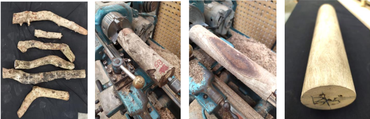
Figura 7 – (a) seis galhos traçados de jambolão, vista superior; (b) jambolão bruto preso na máquina; (c) jambolão torneado; (d) jambolão com lixamento.
