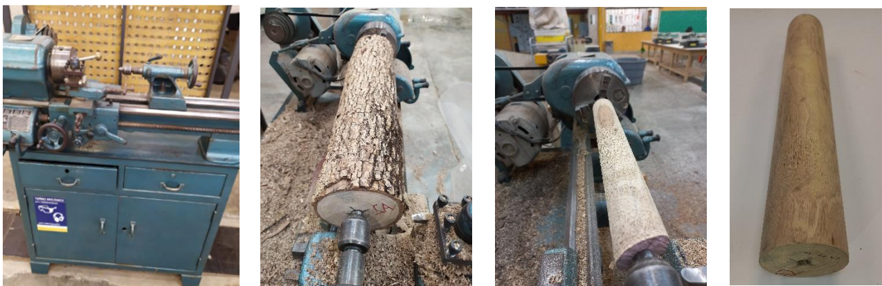
Figura 6 – (a) torno mecânico; (b) tipuana bruta presa na máquina; (c) tipuana torneada na máquina; (d) tipuana após lixamento.
