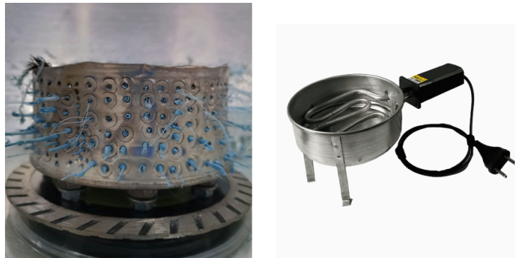
Figura 9 - Detalhe do espaço entre o fundo da lata e o disco de base (esq.) e o fogareiro utilizado para auxiliar no derretimento do plástico (dir.).
