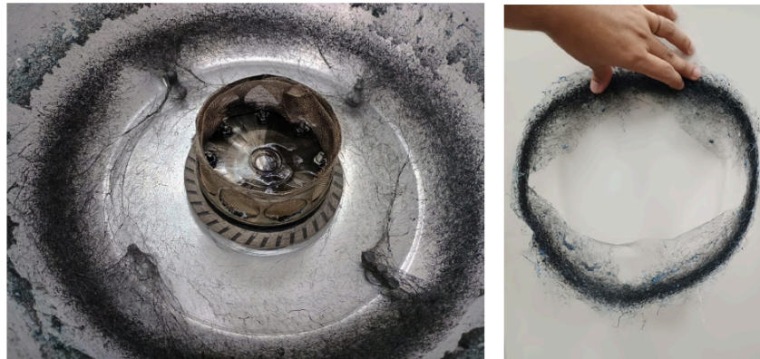
Figura 10 - A temperatura alta derreteu o plástico deixando-o muito fluido, deixando um resíduo sólido na parede do recipiente.
