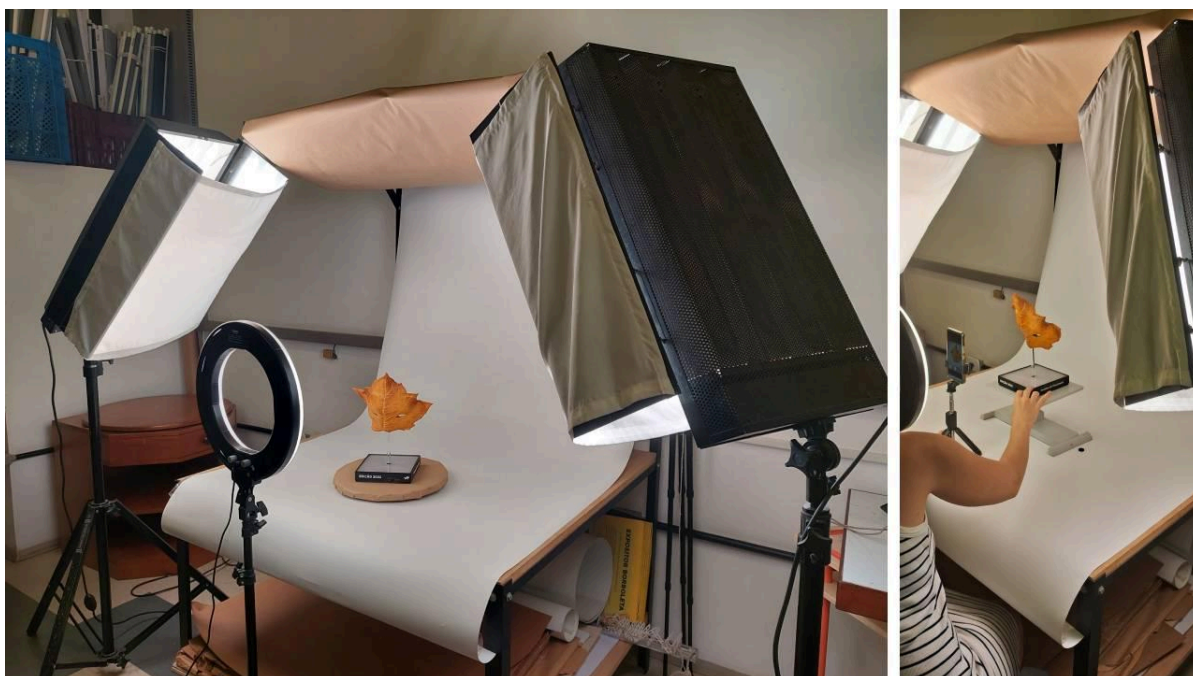
Figura 12 - Configuração definida para o processo de DT por fotogrametria
