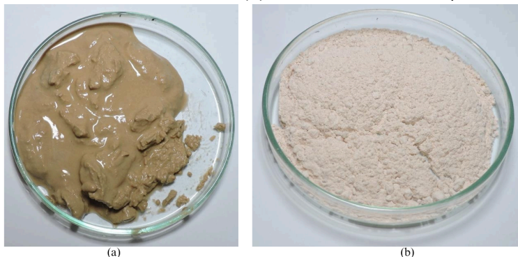
Figura 2 - (a) Terras de diatomáceas in natura (b) Terras de diatomáceas após tratamento térmico
