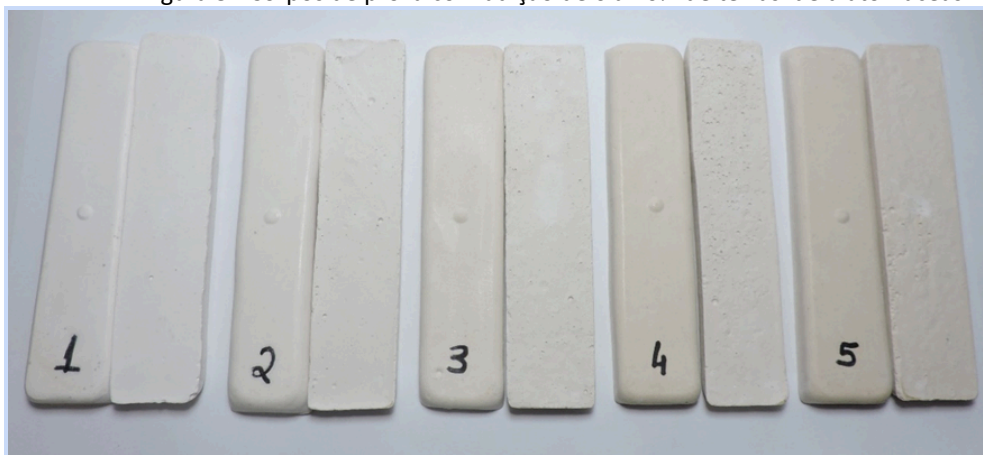
Figura 3 - Corpos de prova com adição de 0 a 20% de terras de diatomáceas
