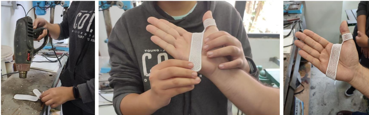
Figura 14 - Etapas de aquecimento e moldagem do modelo alongado à mão
