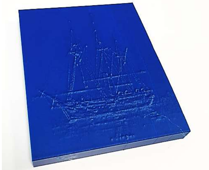
Figura 17 - Modelo tátil impresso em PLA por equipamento FFF.
