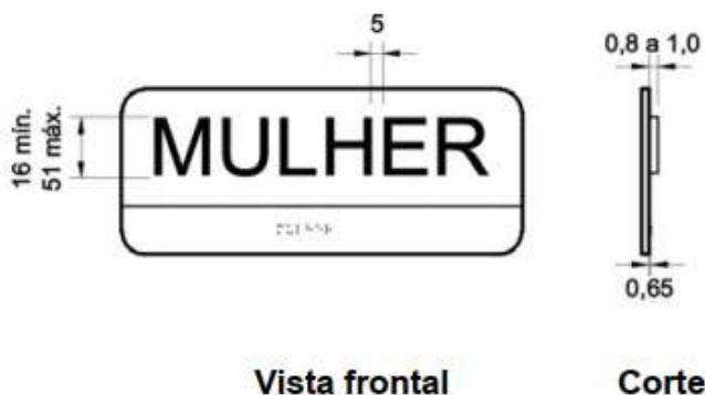
Figura 10 – definições da sinalização tátil de acordo com a norma NBR9050 (dimensões em milímetros).
