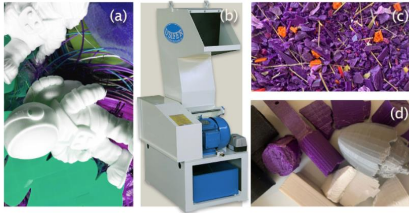
Figura 2 - Quadro de imagens (a) Resíduos de PLA coletados durante o estudo (b) Moinho de facas utilizado na moagem (c) Flakes resultantes do processo (d) Resíduos de impressão 3D não reprocessáveis.
