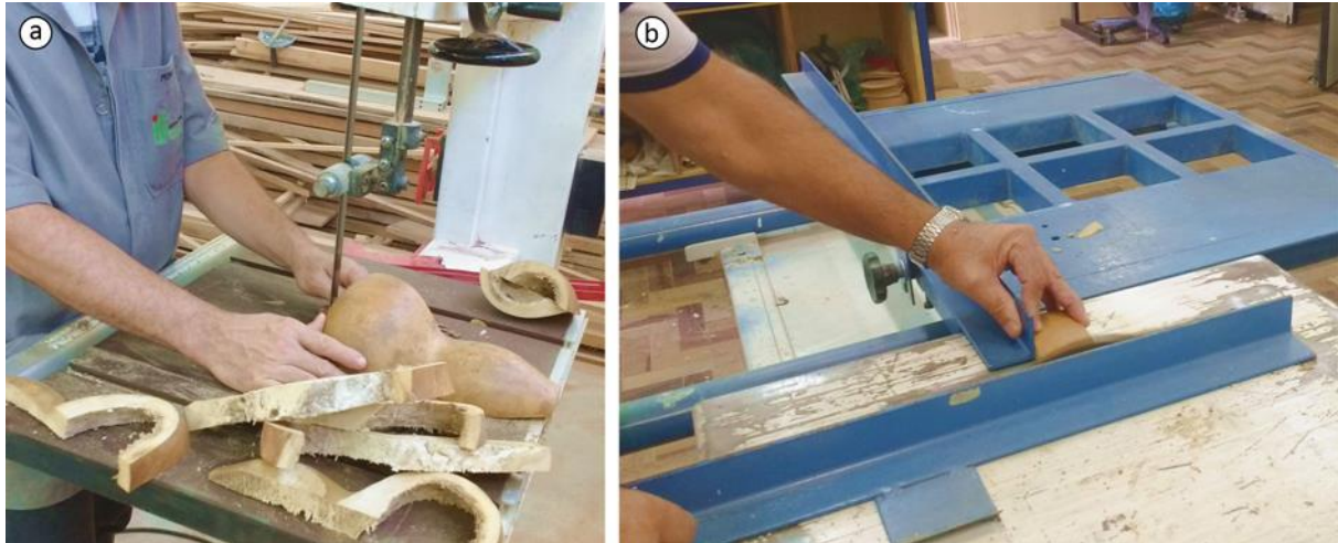
Figura 3 - Corte dos perfis de porongo: a) Serra de fita; b) Serra esquadrejadeira.
