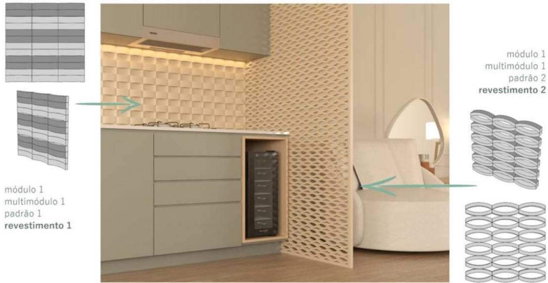
Figura 19 - Revestimento 1 aplicado na parede e revestimento 2 aplicado em divisor de ambientes.
