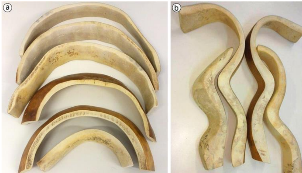
Figura 9 - Cortes de seções selecionados para os revestimentos modulares: a) Semicírculo; b) Orgânico.
