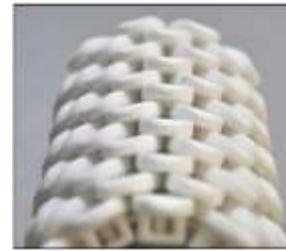
Figura 17 – (a) têxteis fabricados por Manufatura Aditiva; e (b) amostra de colete de segurança para teste de penetração.
