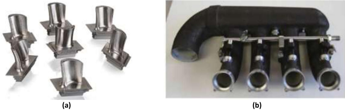
Figura 15 – (a) lâminas de turbinas fabricadas por SLM (Selective Laser Melting); (b) sistema automotivo de veículo de corrida da fórmula SAE fabricado em FDM (Fused Deposition Modeling) e recoberto com compósito.
