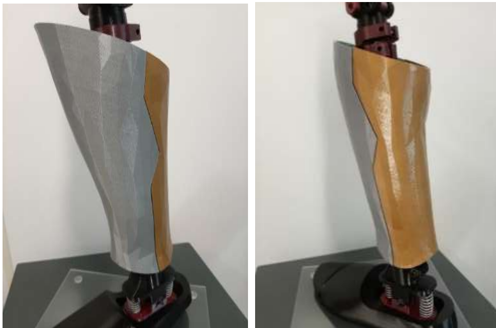
Figura 31 – Capa para prótese desenvolvida em PLA cinza (frente) e PETG dourado (trás).
