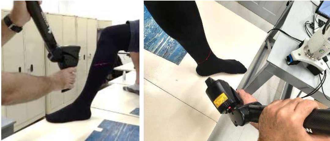
Figura 24 – Aquisição da nuvem de pontos utilizando equipamento Romer Absolut Arm com módulo laser.
