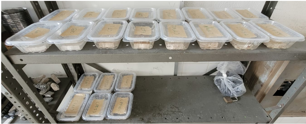
Figura 5 - Corpos de prova em repouso por 24 horas
