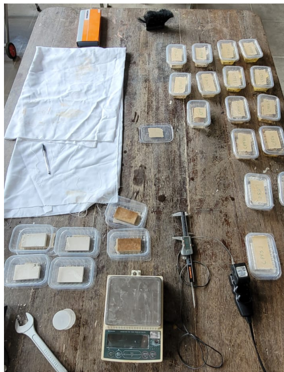
Figura 6 - Estação de trabalho para coleta de dimensões e pesos pós massa úmida
