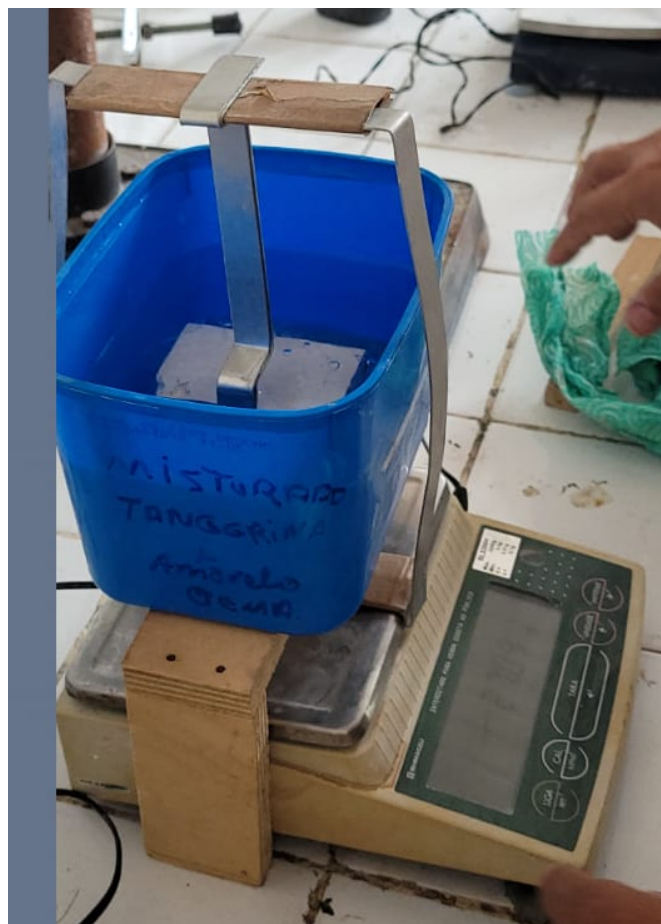
Figura 4 - Adaptação da balança para a realização do teste de massa imersa
