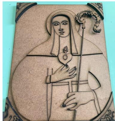
Em análise preliminar da prototipação em tamanho reduzido, foi possível ajustar os modelos digitais e a vetorização para posterior reprodução em tamanho real. Quanto às peças impressas, compreende-se que os detalhes superficiais representaram fielmente as obras digitalizadas, mesmo com a limitação de fotos geradas na fotogrametria pela limitação de uso do aplicativo gratuito, cabendo a validação com público-alvo do projeto.
