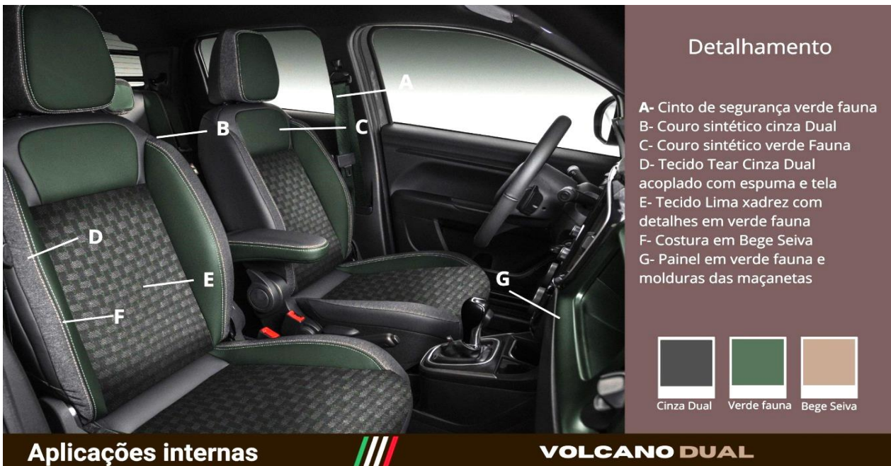
Figura 10 – Detalhamento interno Versão A.
