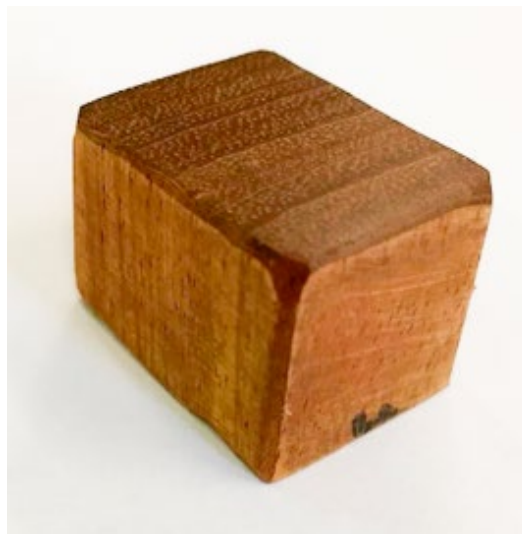
Figura 1: Corpo de Prova da espécie arbórea amazônica Jatobá ( H. courbaril L.)
