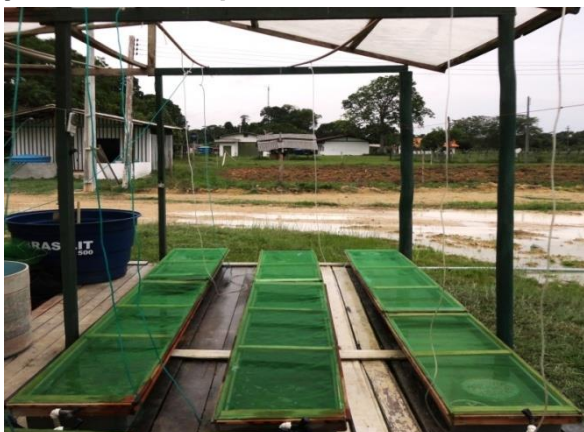
Figura 01 -Unidades experimentais com volume de 200 L utilizadas para cultivo de Moina sp.
